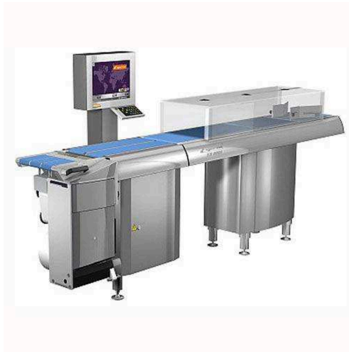
Figura 24– Máquina de pesagem- etiquetagem automática
