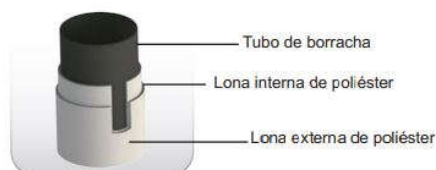
Figura 5 - Especificações da mangueira de incêndio (Flexcasty, 2018).
