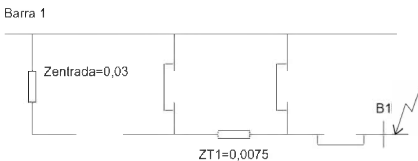
Figura 28 – Diagrama de impedâncias de sequência zero da Barra 1
