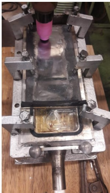
Figura 3.3 - Fixação da chapa de testes com a bolha de ar na parte acrílica (LAPROSOLDA FEMEC UFU).
