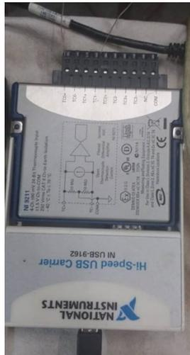
Figura 3.10. Placa de aquisição de temperatura NI-9211
