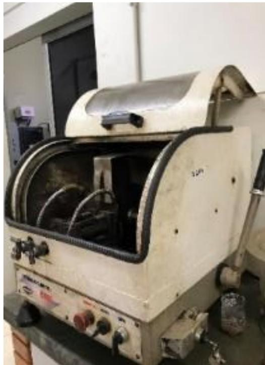
Figura 3.13. Cortadora Metalográfica
