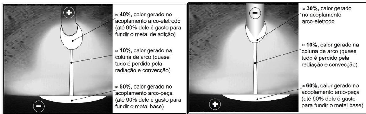
Figura 2.7. A estrutura do arco como um gerador de calor
