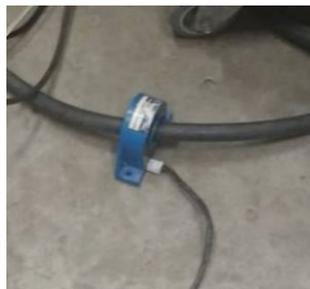
Figura 3.9. Sensor Hall no cabo terra da fonte
