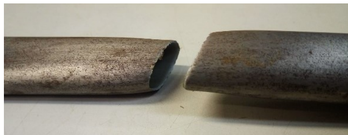
Figura 48 – Fratura do metal de base
