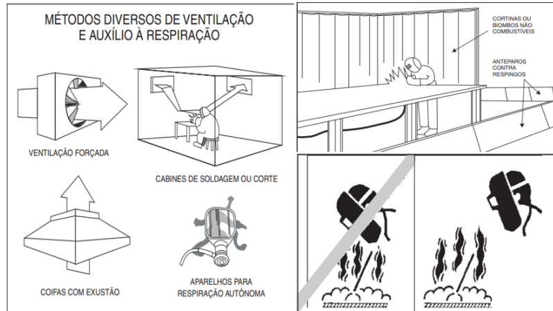
Figura 29 – Orientações de segurança: Incêndio e Ventilação (Regras para Segurança - ESAB)
