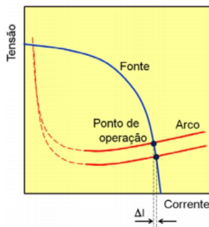
Figura 6 – Característica estática da fonte de corrente constante (Prof. Paulo J. Modenese - Fontes de energia para soldagem a arco – Universidade Federal de Minas Gerais – Departamento de Engenharia Metalúrgica e de Materiais - 2009)
