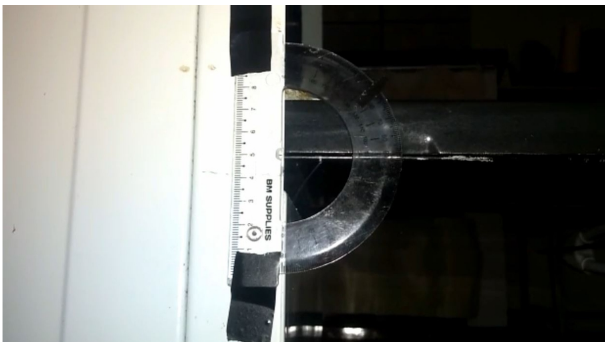
Figura 9 – Método elaborado pelo grupo para medir o ângulo presente na abertura de uma porta
