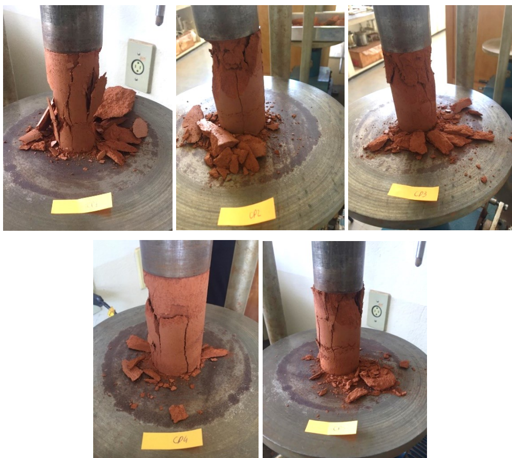
Figura 4.4 - Corpos de prova após ruptura por compressão simples
