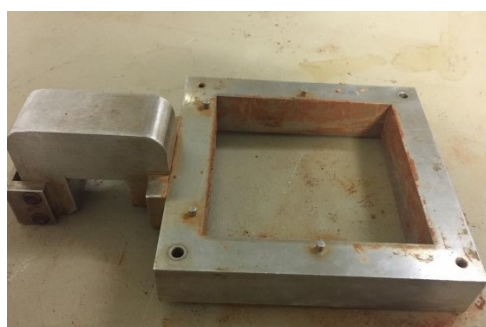
Figura 3.6 – Elementos do ensaio de cisalhamento direto
