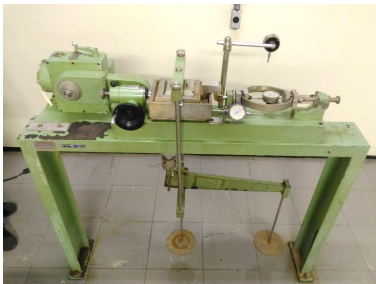
Figura 3.5 – Equipamento para ensaio de cisalhamento direto
