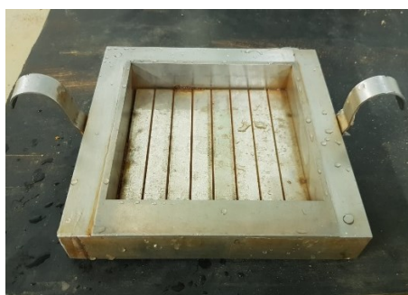
Figura 3.6 – Elementos do ensaio de cisalhamento direto
