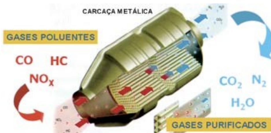
Figura 2.12 - Ilustração esquemática de um catalisador de escape de três vias. Fonte: O MECÂNICO (2015).
