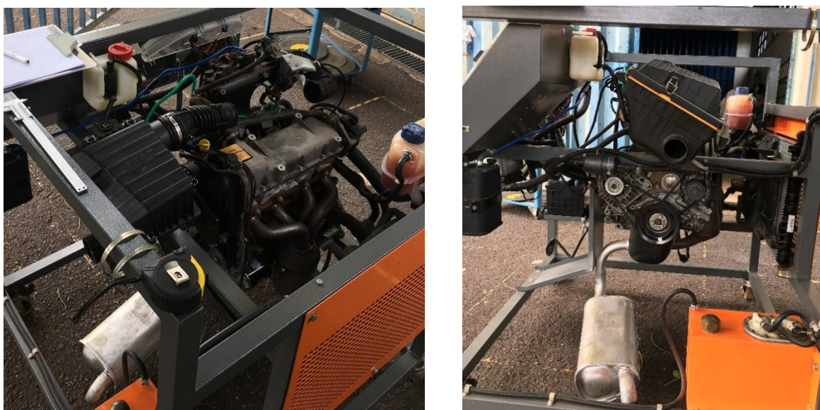
Figura 3.1 - Bancada experimental do motor Fiat Fire 1.0 localizada na Universidade Federal de Uberlândia (UFU). Fonte: AUTOR PRÓPRIO.
