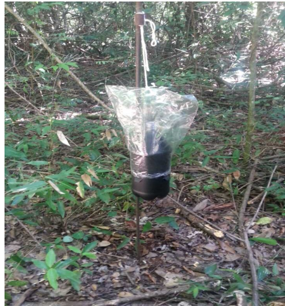
Figura 3: Modelo de armadilha adaptada para captura de dípteros muscóides utilizada neste trabalho.
