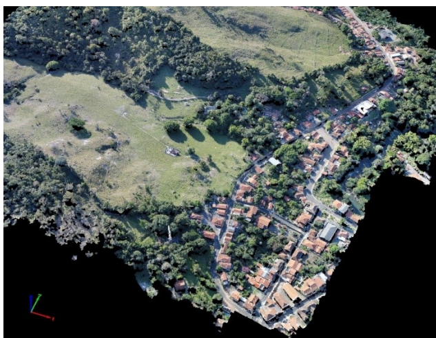
Figura 2 – Densificação de pontos com o auxílio do algoritmo SFM.
