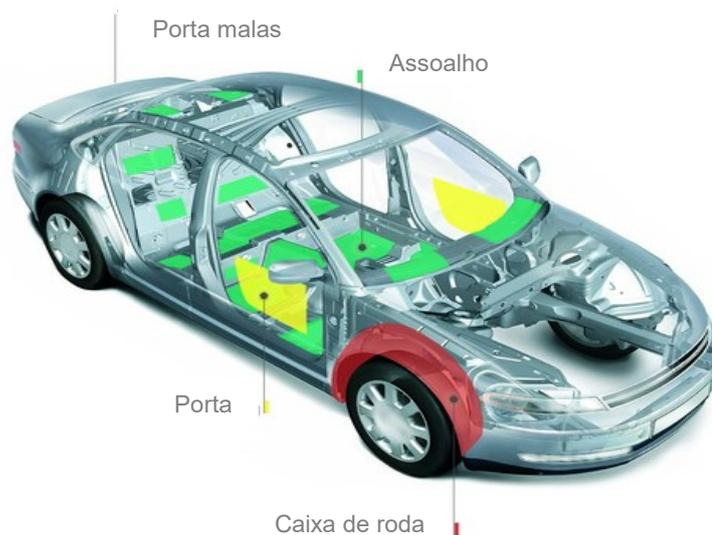
Figura 1. 3 - Pontos de aplicação de tratamentos viscoelásticos em automóveis (Adaptado de EMS - EFTEC, 2018)
