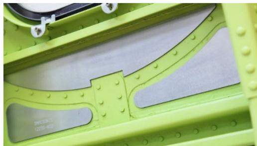
Figura 1. 4 - Seção da fuselagem de uma aeronave (extraído de SMAC, 2018)
