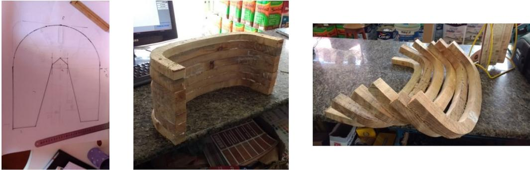
**Figura 4.** Molde e cortes para a construção do dispositivo.
