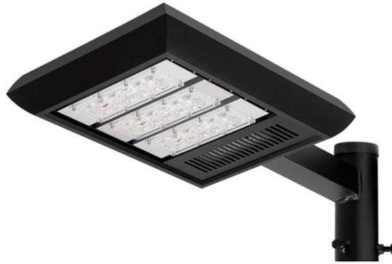
Este painel de led é composto por 3 módulos que somados possuem a potência de 113W e o fluxo luminoso de 12150lm o que gera uma eficácia de 108lm/W. Ainda segundo o fabricante o equipamento, assim como o restante do sistema, possui índice de proteção IP67 o que garante sua utilização ao ar livre. Pode ser utilizado na substituição de luminárias de vapor de sódio de 250W.
