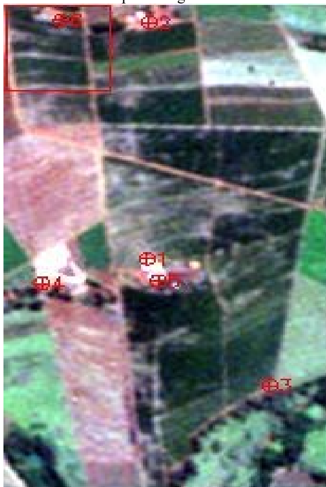
Figura 4 - Registro da imagem. Em vermelho, destaca-se os seis pontos de apoio definidos para o registro
