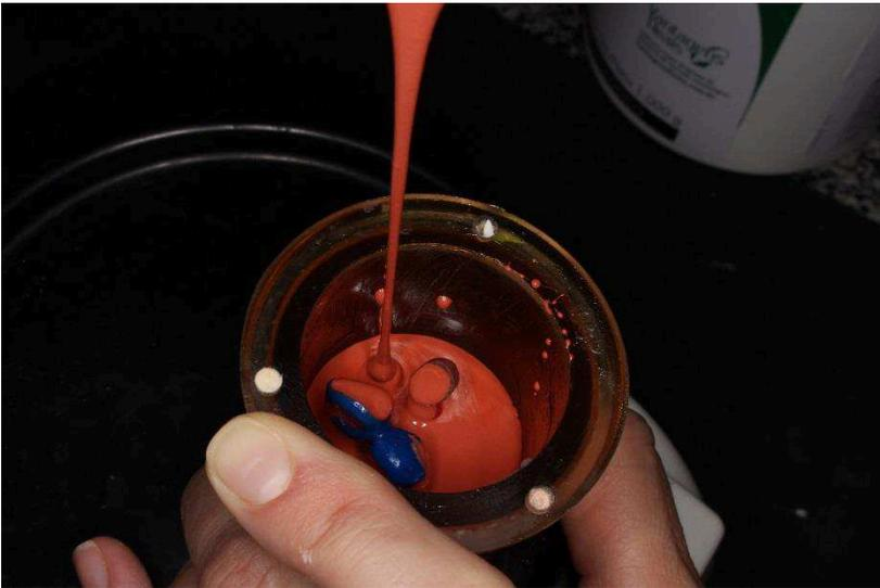
Figura 15: Preenchimento de material de inclusão no interior do anel
