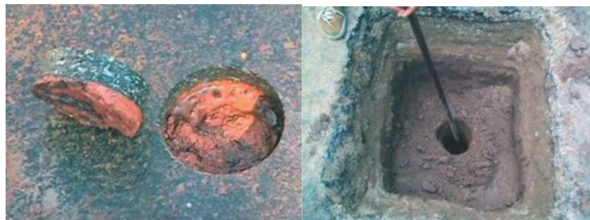
Figura 1: Extração do corpo de prova no método destrutivo.
