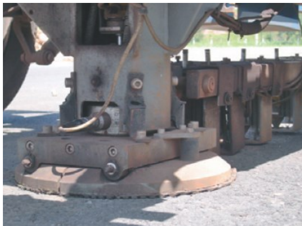
Figura 9: Ponto de aplicação da carga e detalhe dos geofones.
