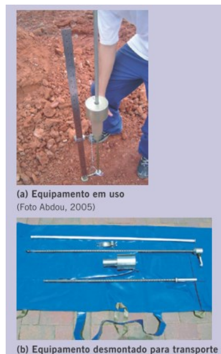
Figura 2: Exemplo de equipamento DCP de avaliação estrutural expedita de subleitos e camadas do solo.
