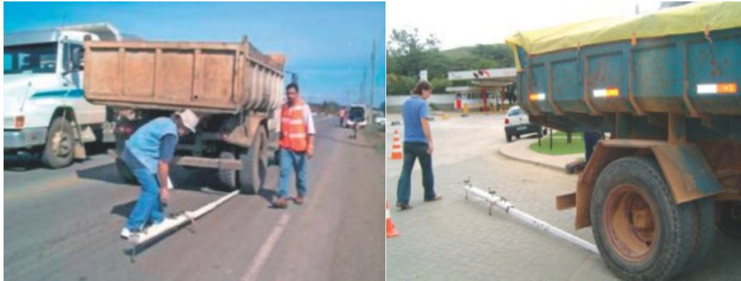
Figura 4: Medida com a Viga Benkelman em campo.
