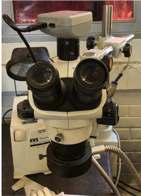
Figura 3.10 - Microscópio SZ61 - Olympus. Fonte: Autor (2018).
