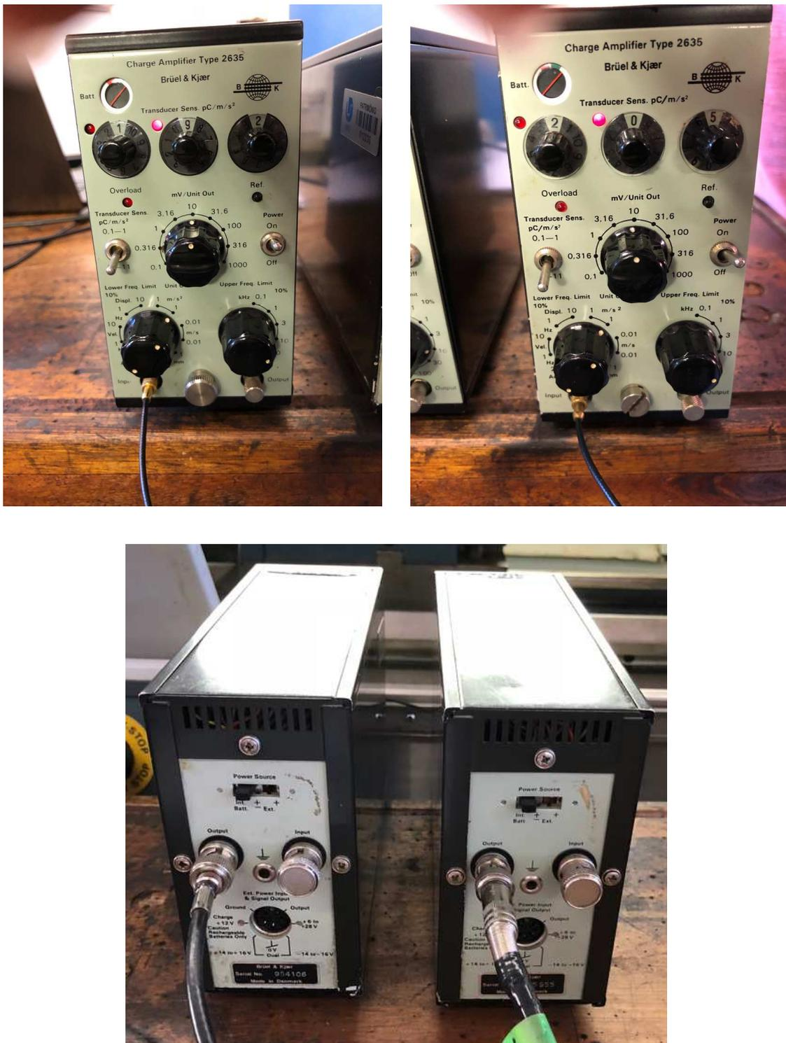
Figura 3.8 - Amplificadores de cargas. Fonte: Autor (2018).
