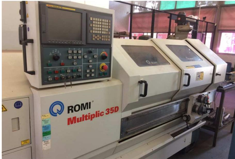
Figura 3.3 - Torno CNC ROMI Multiplic-35D. Fonte: Autor (2018).
