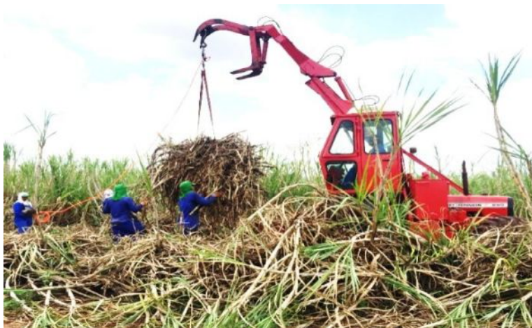
FIGURA 6 - Pesagem da cana colhida com célula de carga acoplada à carregadeira. Fonte: GPSI, 2017.
