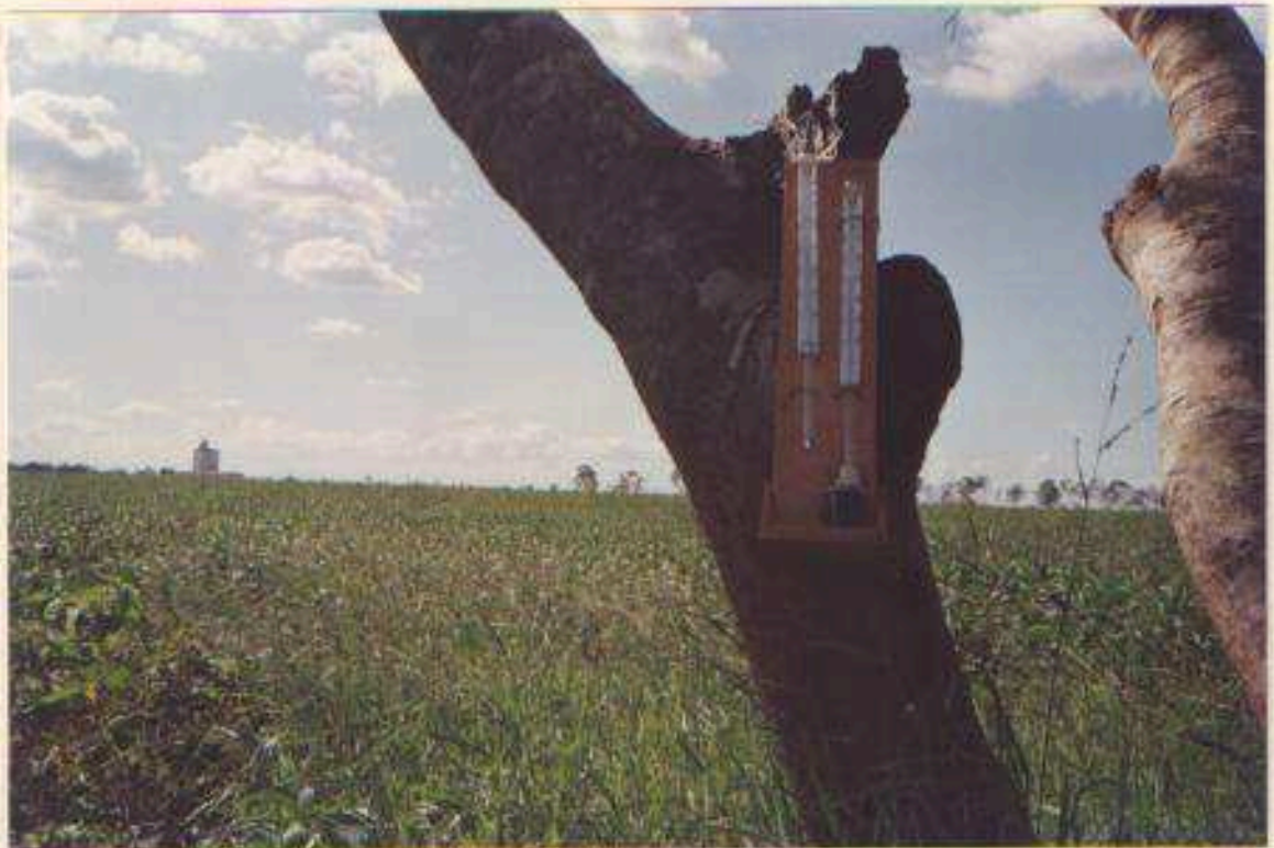
Figura 04 - Aparelho utilizado para medir temperatura e umidade relativa do ar.
