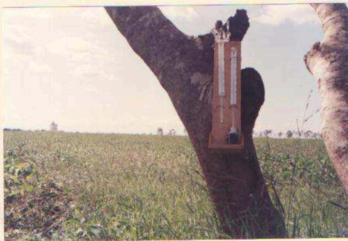
Figura 6 - Aparelho utilizado para medir a temperatura e a umidade relativa do ar.
