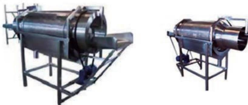
Figura 4 – Maquinário para retirada de escamas
