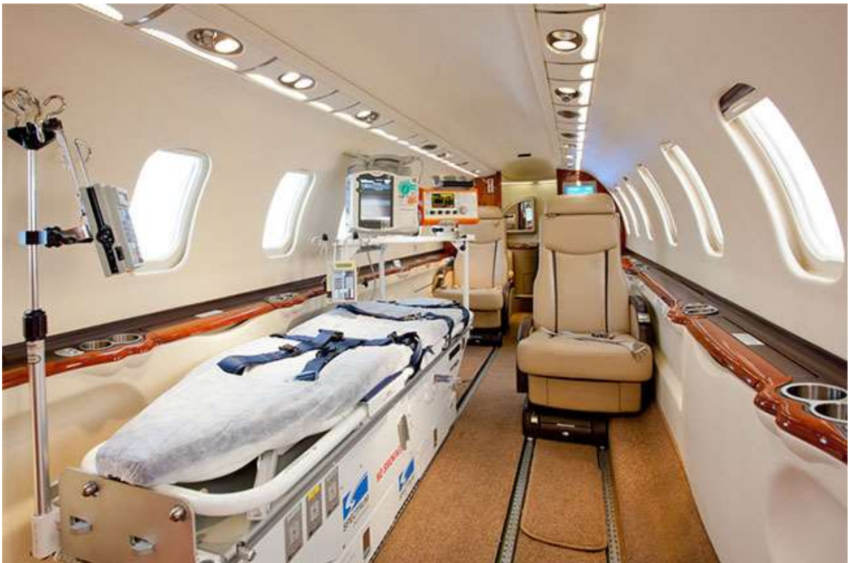
Figura 2 - Reconfiguração do interior de uma aeronave para transporte aeromédico, exemplo de grande modificação.
