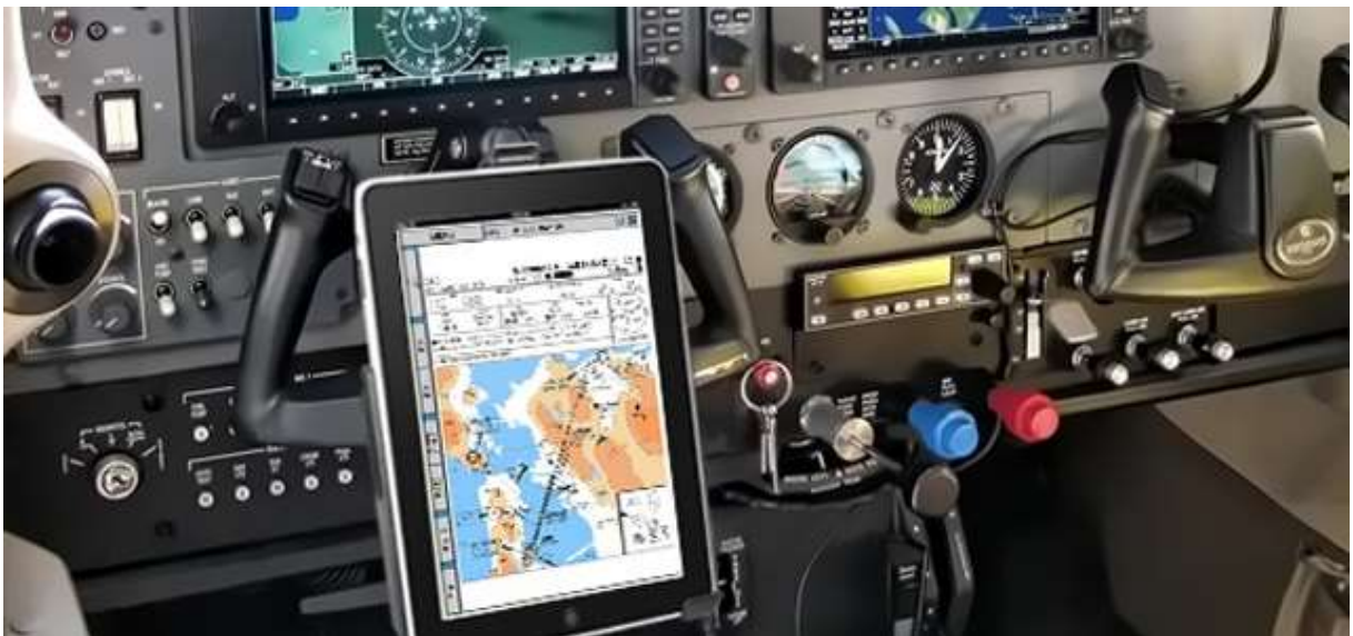
Figura 1 - Painel de uma aeronave com um tablet acoplado ao manche: exemplo de pequena modificação.
