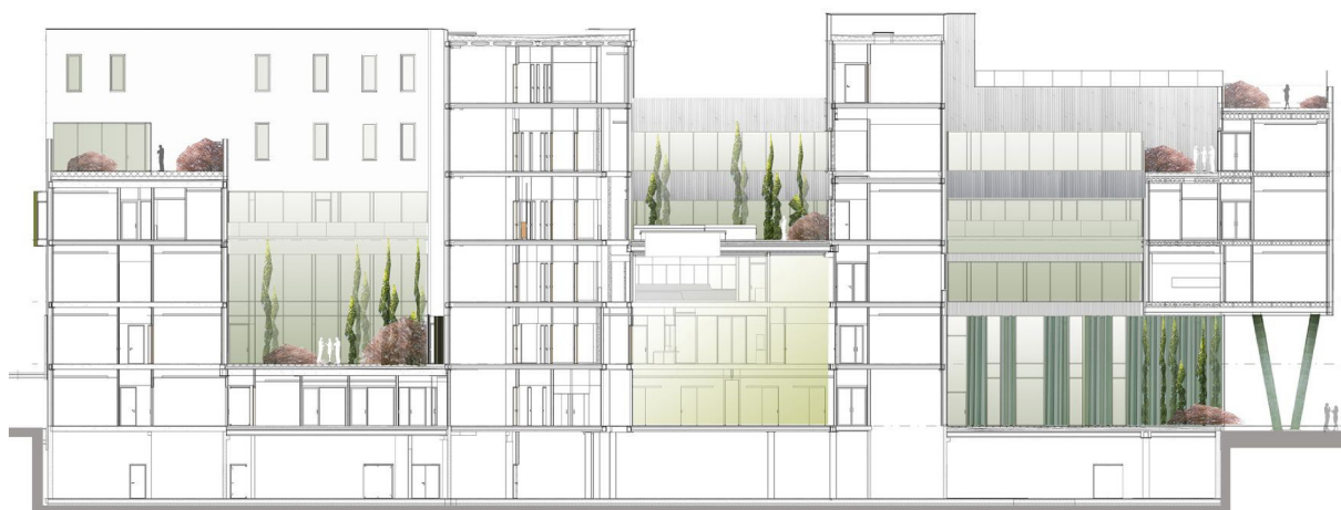
Figura 29. Corte transversal. Átrios fornecem contato com a natureza e visibilidade dentro do edifício. Fonte: Origo Arkitektgruppe, 2013.
