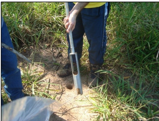
Fotografias 5, 6: Trado e coleta do solo nos pontos 2 e 3 respectivamente
