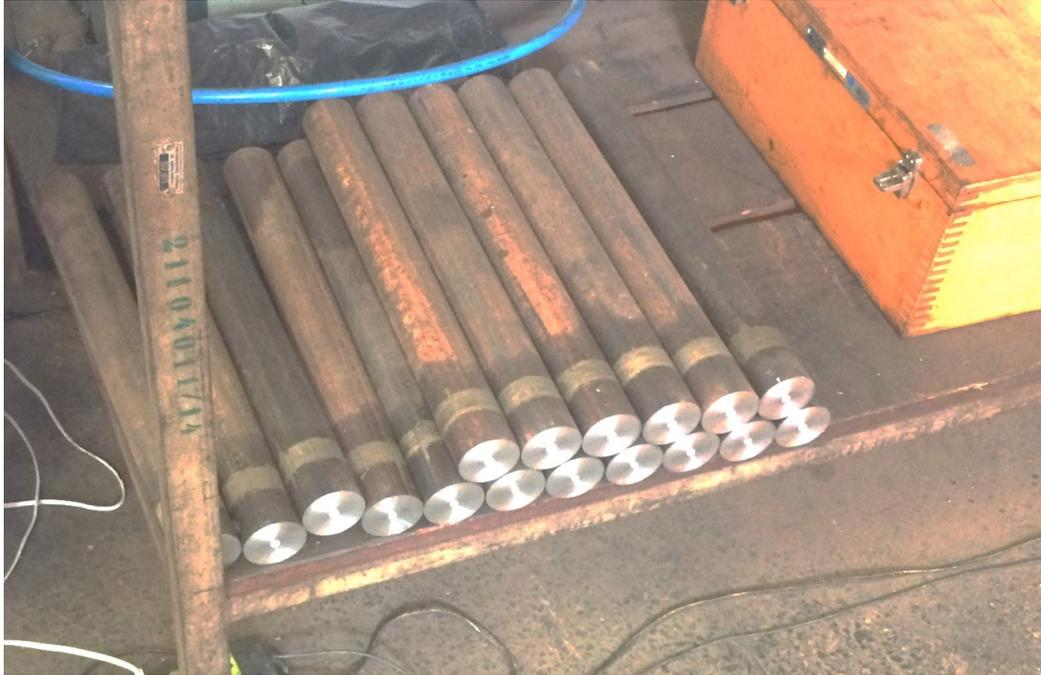
Figura 5 Corpos de prova - Aço SAE 1050
