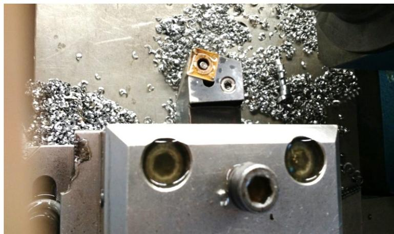
Figura 6 Ferramenta de corte e suporte fixados no torno
