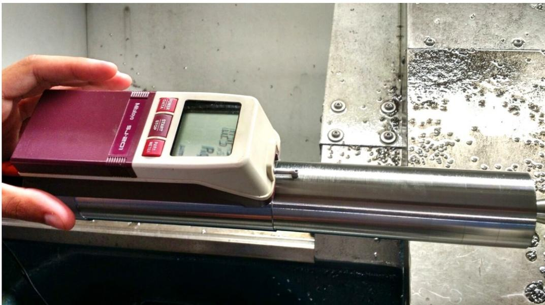
Figura 8 Medição da rugosidade após a usinagem
