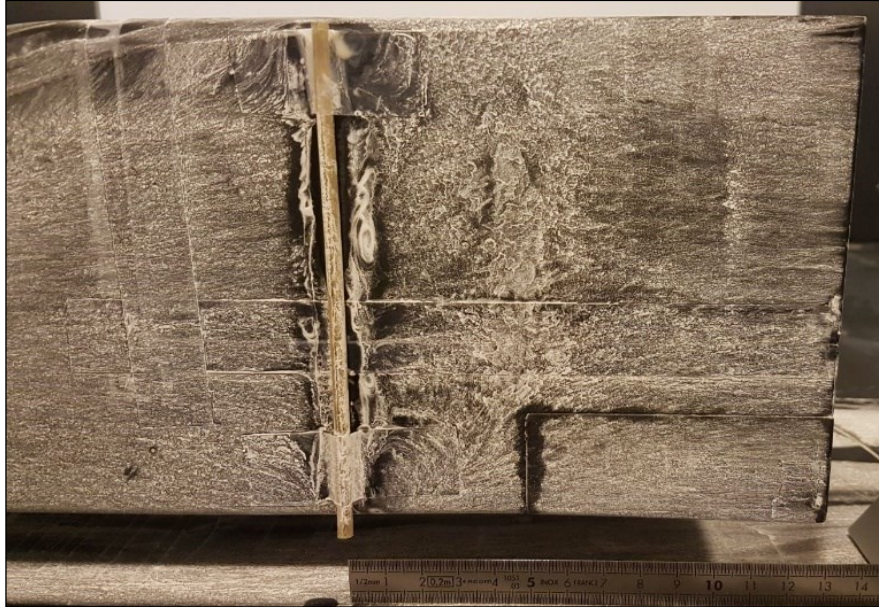
Figura 19 - Ensaio de visualização para estudo dos fenômenos de descolamento, recolamento e transição da camada limite perturbada pelo cilindro ( U_{\infty} = 30 \text{ m/s} ).
