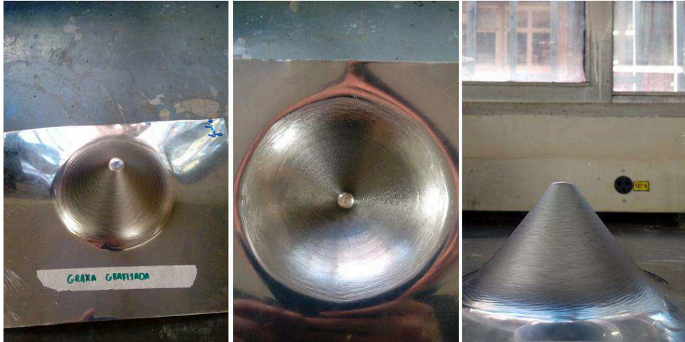
Figura 4.1 – Resultado do ensaio de estampagem incremental com graxa grafitada Lubrax Calcium.
