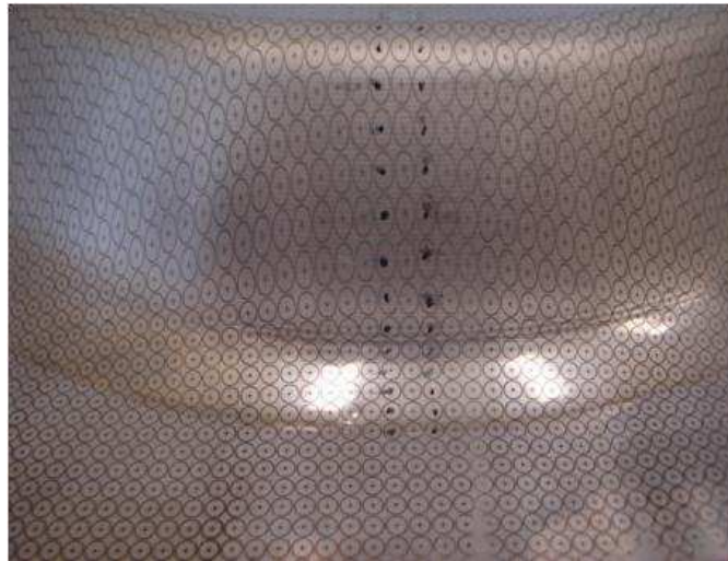
Figura 2.2 – Exemplo de deformações que ocorrem em uma peça estampada (CAVALER, 2010).
