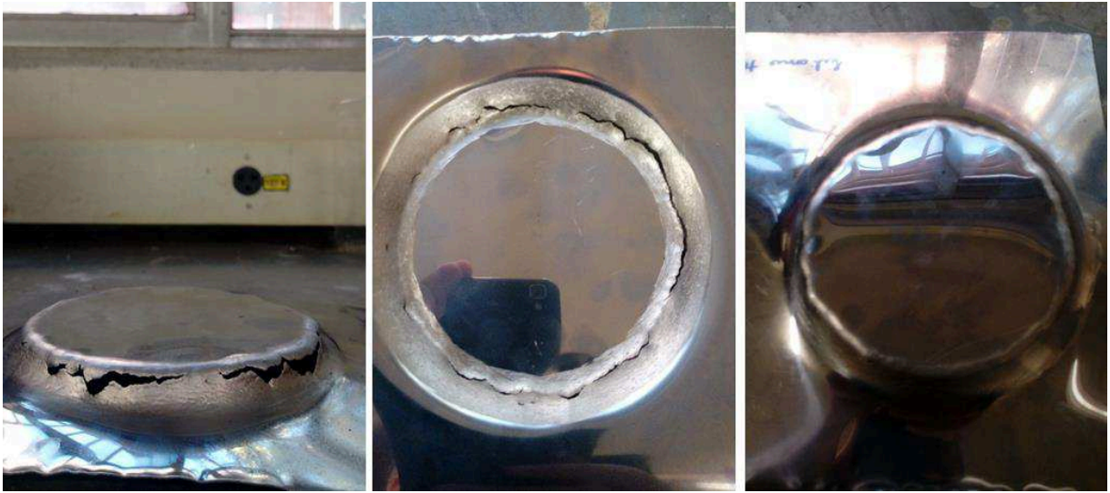
Figura 4.3 – Resultado do ensaio de estampagem incremental sem lubrificante em chapa de aço Inox 430.
