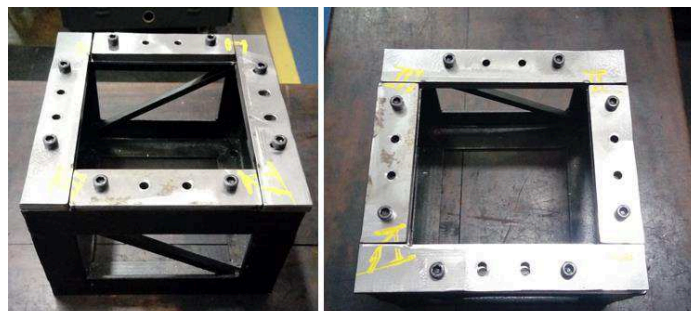
Figura 3.4 – Suporte para fixação de chapas para realizar testes de estampagem incremental
