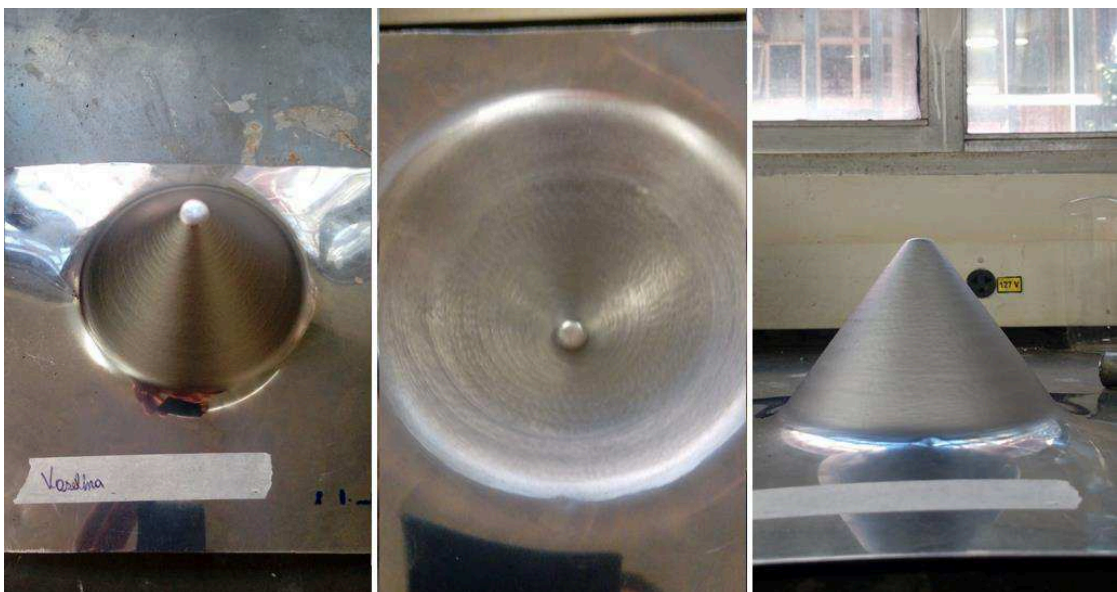
Figura 4.4 – Resultado do ensaio de estampagem incremental com vaselina em spray.
