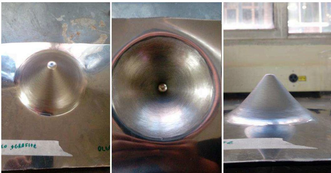
Figura 4.2 – Resultado do ensaio de estampagem incremental com óleo Lubrax SAE 10w30.
