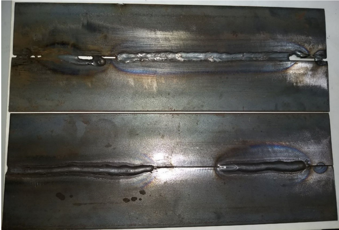
Figura 23- Cordões de solda realizados na posição vertical descendente (superior) - 23A e cordões de solda realizados na posição plana (inferior) – 23B.
