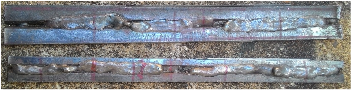
Figura 24- Corte longitudinal dos cordões dos dois primeiros casos
