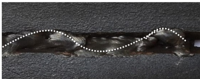
Figura 39-Ondulação do cordão de solda durante o passe de raiz.
