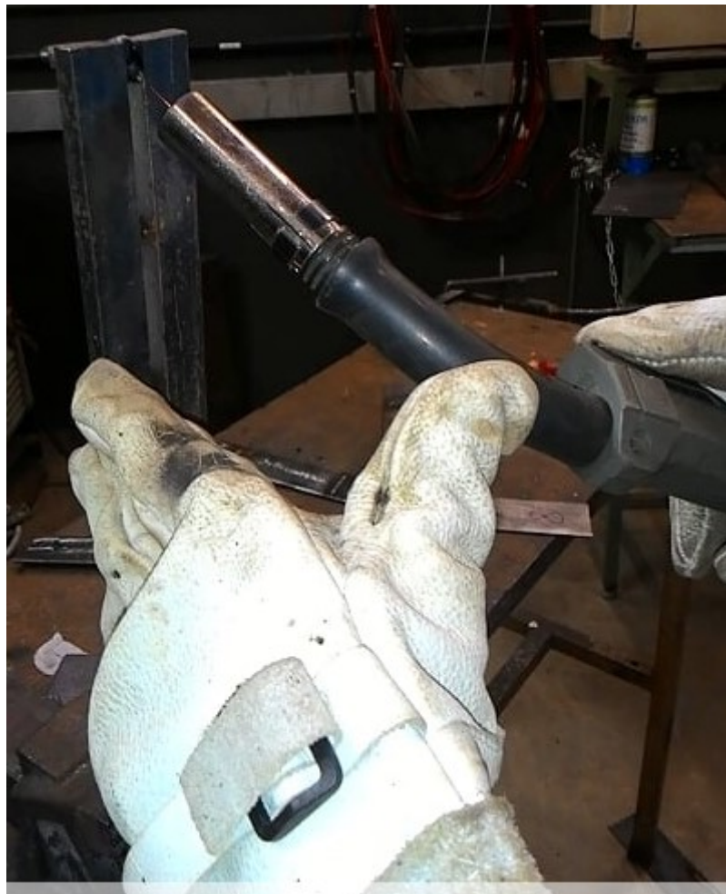
Figura 28- Soldagem vertical descendente com arames ultrafinos.
