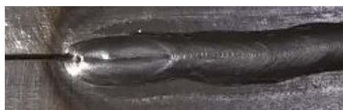
Figura 29-Ampliação da Figura 23B, mostrando cordão cobrindo todo o vão.
