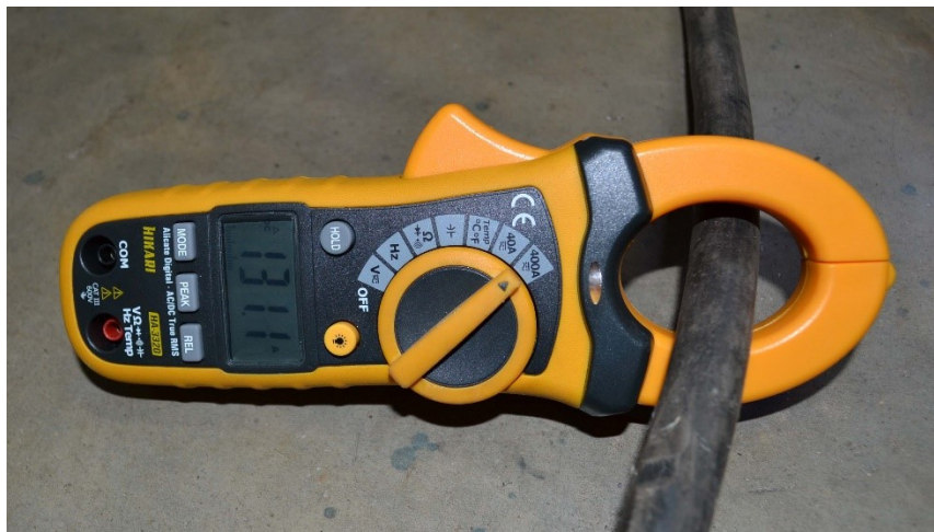
Figura 17-Amperímetro alicate utilizado nos testes.
