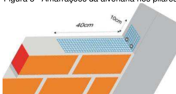
Figura 3– Amarrações da alvenaria nos pilares
