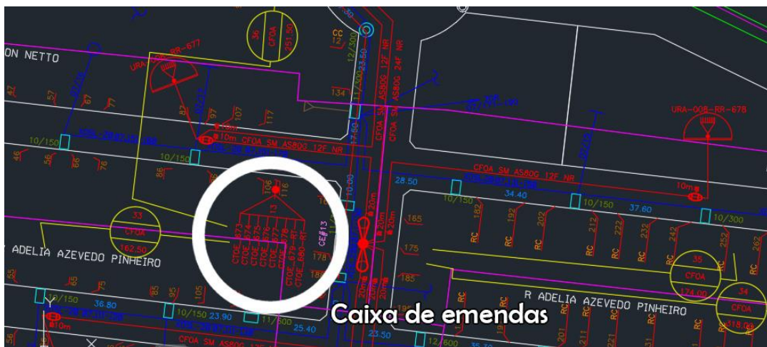
Figura 21 - Destaque caixa de emendas
