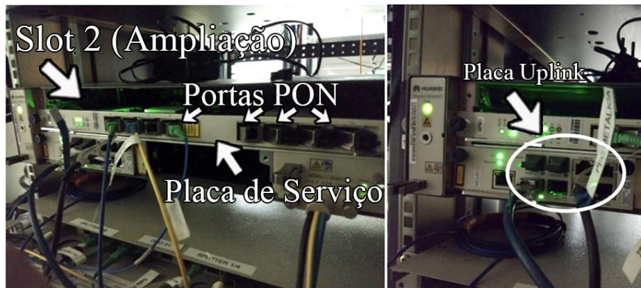
Figura 30 – (a) Portas PON da OLT. (b) Portas uplink .
