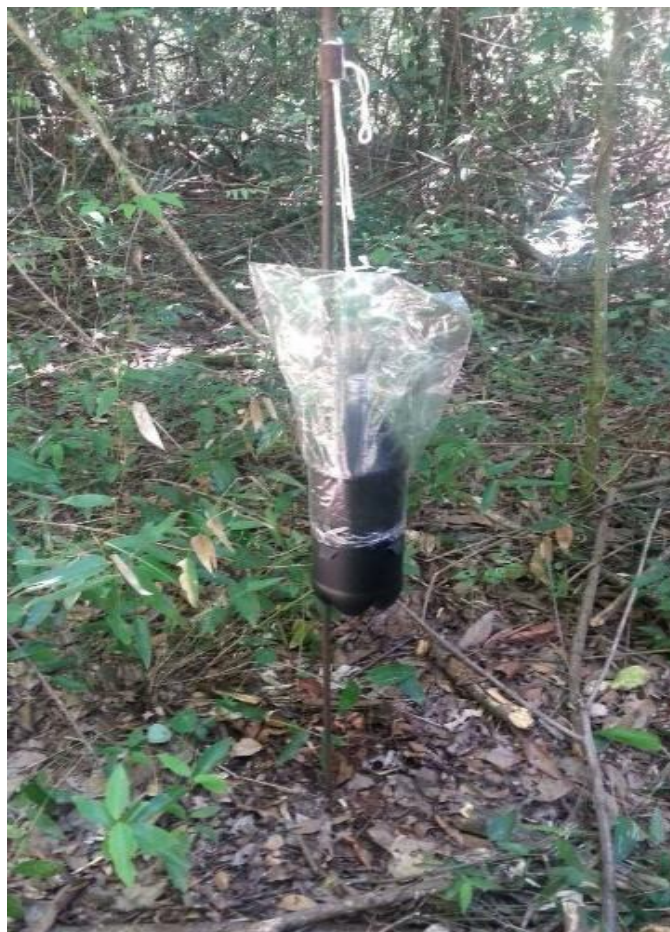
Figura 1: Armadilha utilizada para coleta de moscas exposta em ambiente de mata na fazenda experimental do Glória, Uberlândia-MG.
