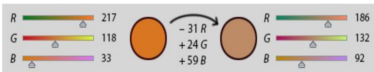
Figura 4 – Demonstração das variações nos valores necessárias em cada canal de uma imagem no espaço RGB para manter a mesma cor porém com menos brilho
