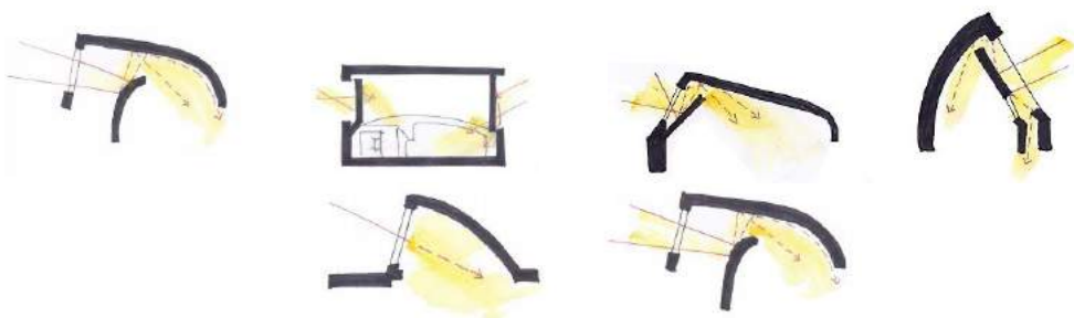
Fig.20: Esquema de Iluminação – Coberturas Irregulares permitem diferentes estratégias luminosas.
