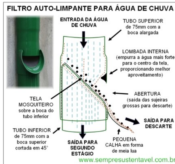
Figura 7. Filtro simples para remoção de sólidos
