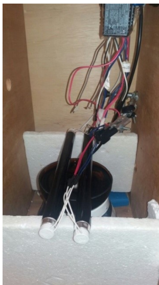
FIGURA 7- Sistema operacional utilizado nos experimentos de fotodegradação.
