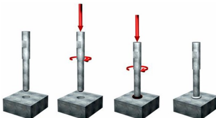
Figura 2.5 - Ilustração do método de reparo por atrito FHPP (MEYER, 2003)
