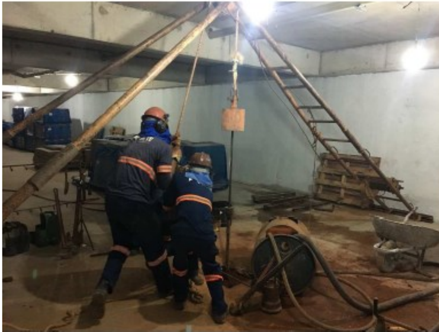
Figura 22 - Execução de sondagem SPT
