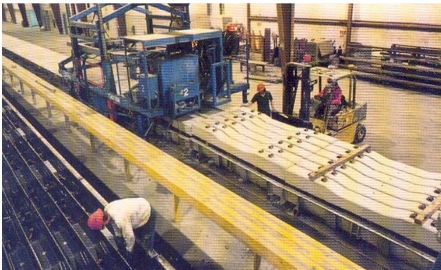
Figura 14 - Protensão com aderência inicial (pré-moldado)
