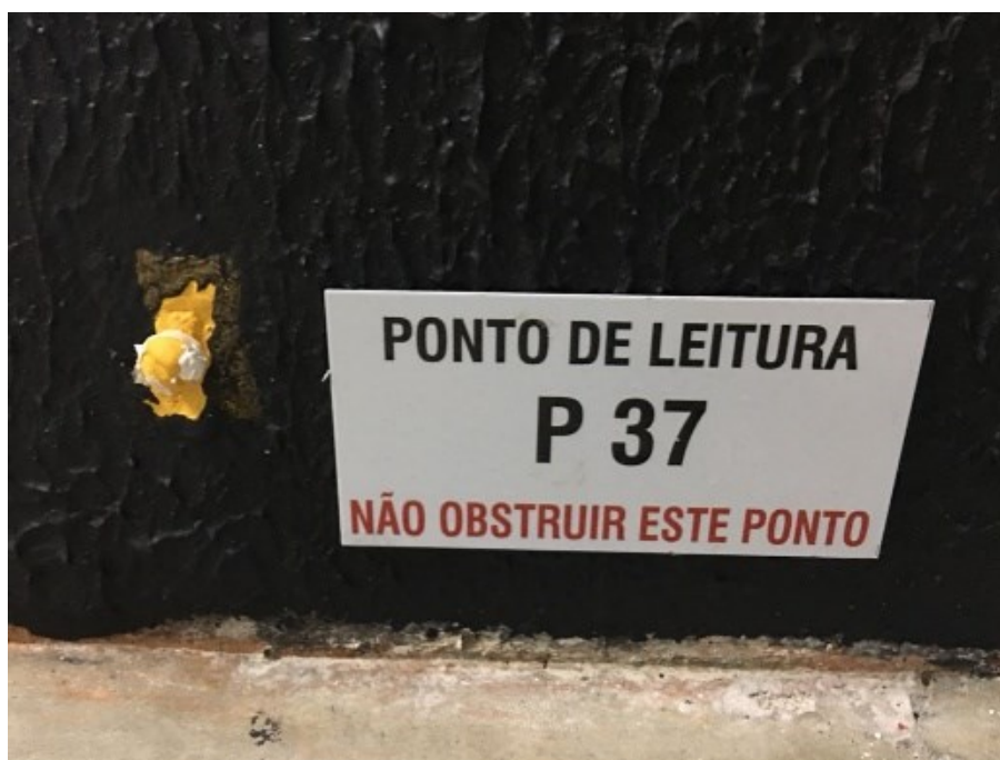
Figura 23 - Pino instalado no pilar para a leitura de recalque
