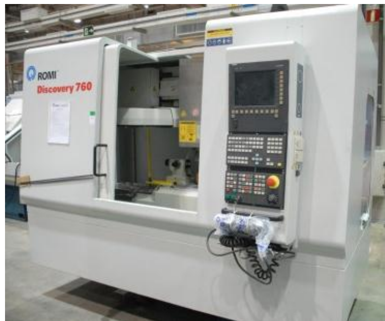
Figura 3.5 - Centro de usinagem CNC, modelo Discovery 760 da Romi, utilizada para realização dos ensaios (ROMI, 2016).
