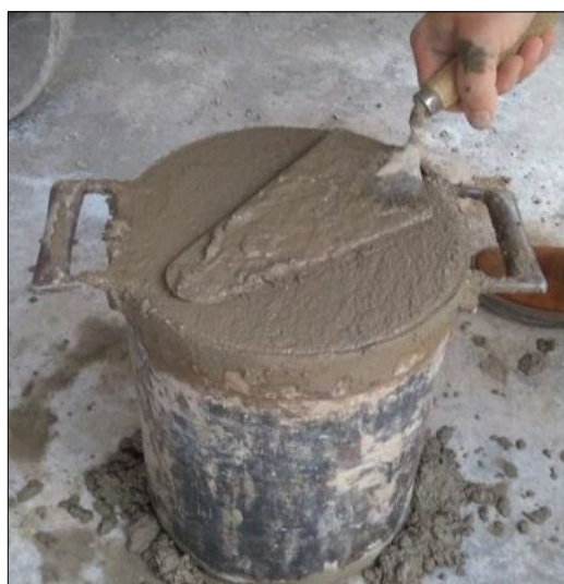
Figura 3.8: Determinação da massa específica do concreto no estado fresco.
