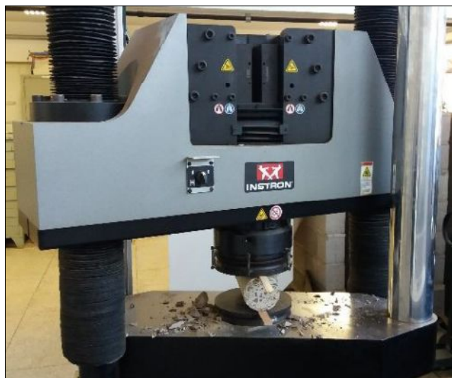
Figura 3.10: Ensaio de resistência à tração por compressão diametral.
