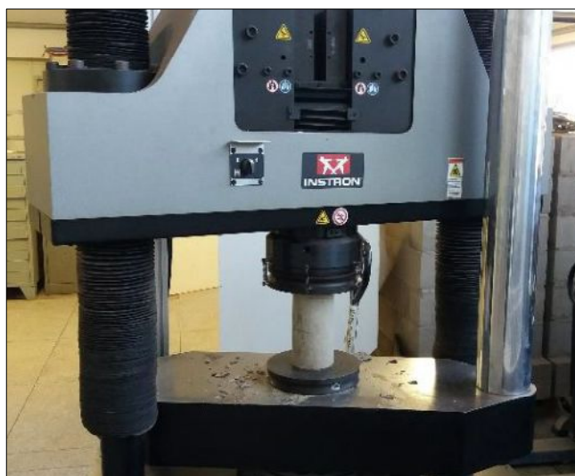
Figura 3.9: Ensaio de resistência à compressão.
