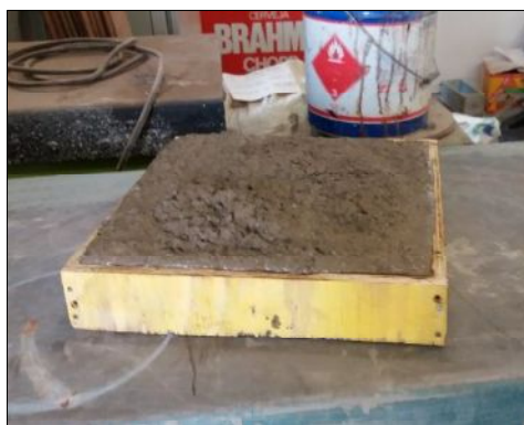
Figura 3.5: Moldagem de placa para ensaio de desempenho térmico.
