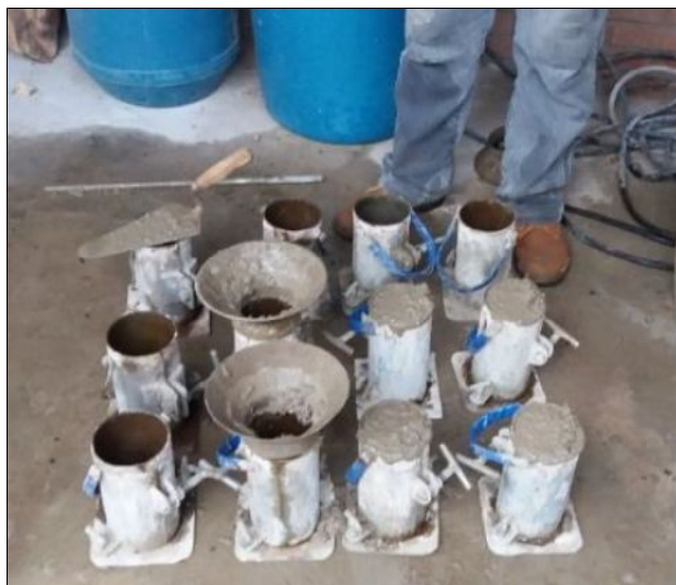
Figura 3.4: Moldagem dos corpos-de-prova cilíndricos.
