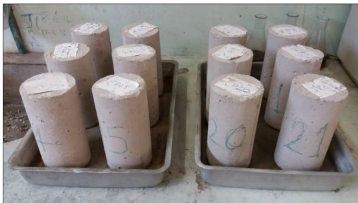
Figura 3.11: Disposição dos corpos-de-prova para ensaio de absorção por capilaridade.
