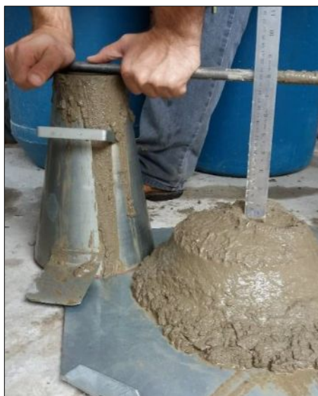
Figura 3.7: Determinação consistência pelo abatimento do tronco-de-cone.
