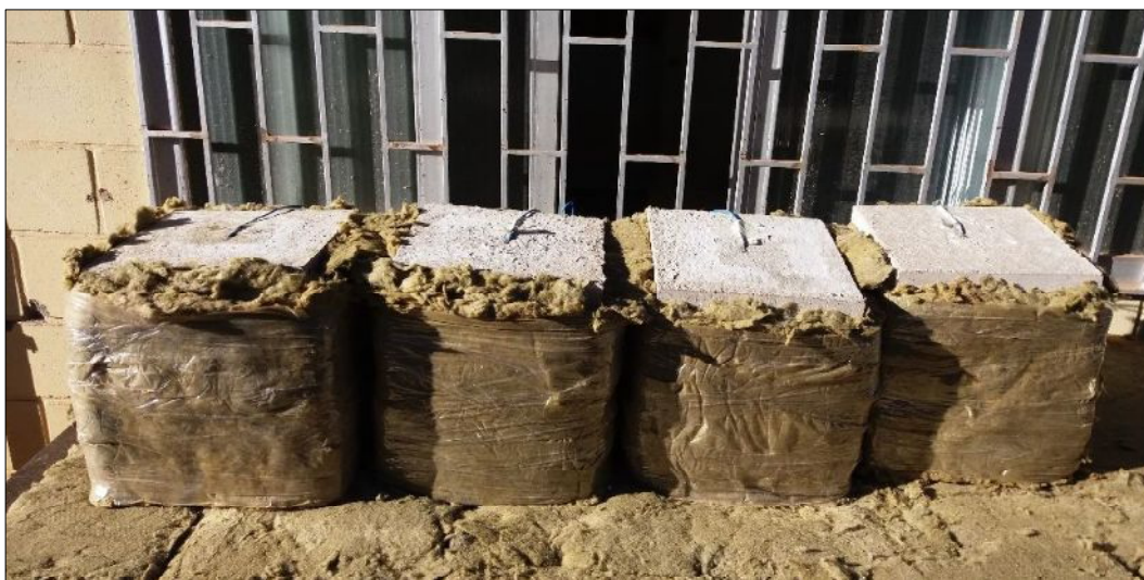
Figura 3.13: Moldes cúbicos com placas de concreto para ensaio térmico.
