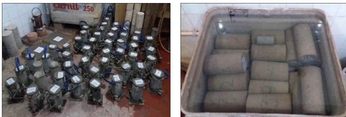
Figura 3.6: a) Cura inicial em câmara úmida; b) Cura em reservatório com água e cal.
