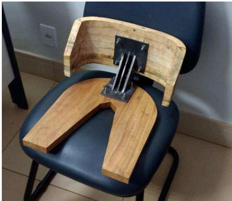
**Figura 2.** Dispositivo construído para a determinação do ponto de referência do assento.
