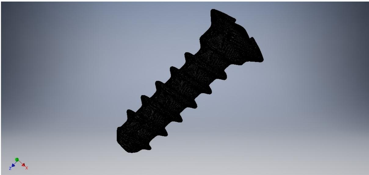
Figura 8: Objeto 3D obtido pelo escaneamento e arquivo visualizado no software Inventor.
