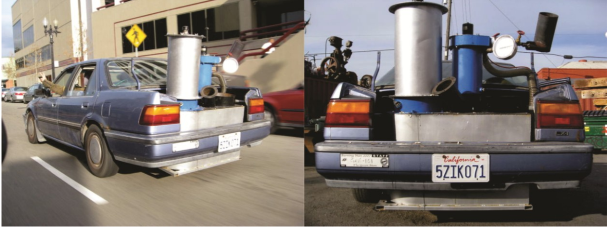
Figura 2.8 – Exemplo de utilização de um gasogênio veicular em um Honda Accord (INSTRUCTABLES, 2009)
