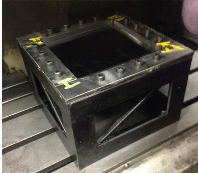
Figura 3.7 – Ilustração do suporte de fixação das chapas AISI 304.
