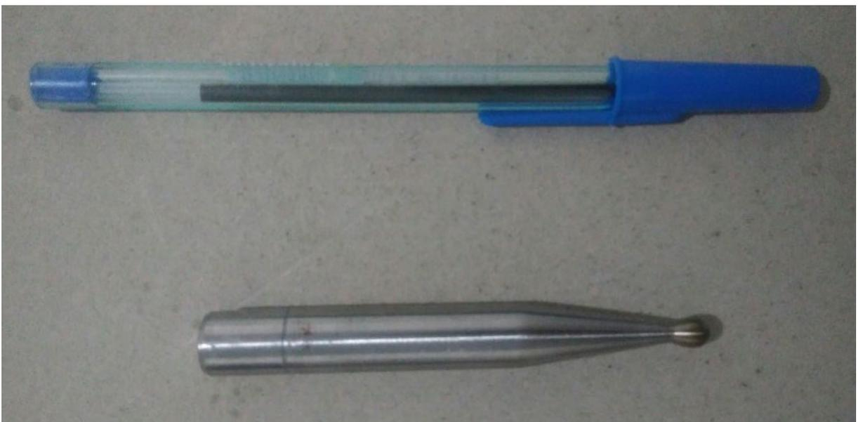
Figura 3.8 – Ferramenta utilizada nos testes de estampagem incremental.
