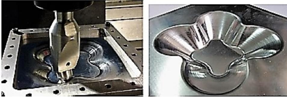
Figura 2.11 – Representação da execução do processo de estampagem incremental. (B. Lu, 2014)
