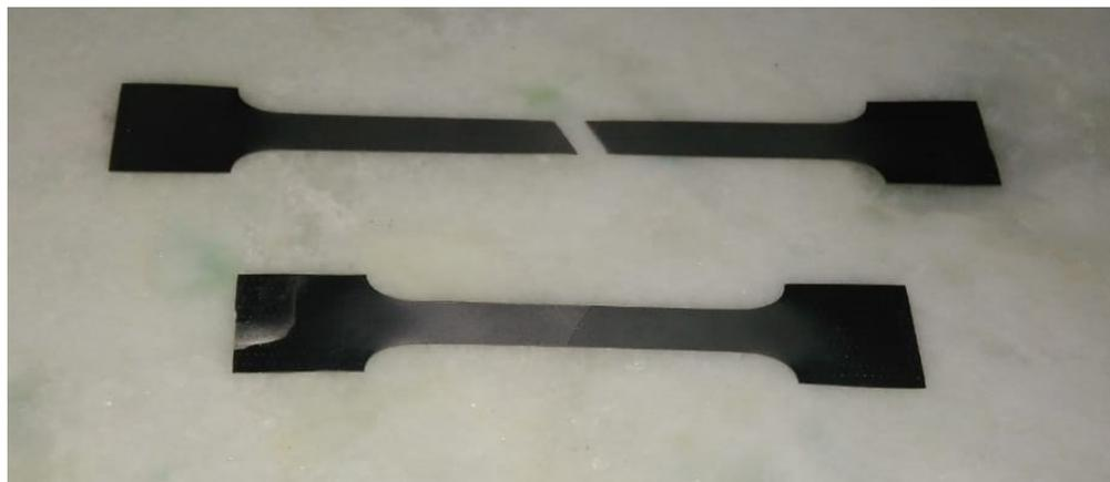
Figura 3.4 – Fratura do corpo de prova após o teste de tração.
