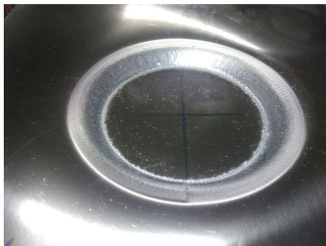
Figura 4.3 – Geometria estampada após teste 1.
