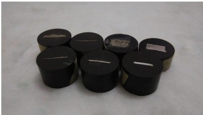
Figura 3.12 – Amostras após o embutimento e destinadas à análise metalográfica.
