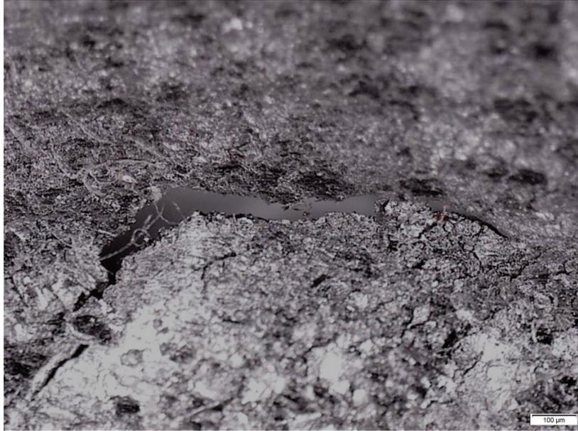
Figura 4.6 – Representação da ampliação da trinca propagada na superfície do teste 2.
