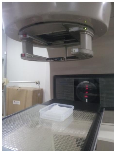
**Figura 2** - Acelerador Linear (Clinac 600C Varian®) utilizado para a irradiação dos dentes. A) Vista lateral do acelerador. B) Vista aproximada do acelerador com recipiente contendo os dentes em posição.
