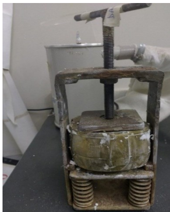
Figura 7. Prensagem da mufla
