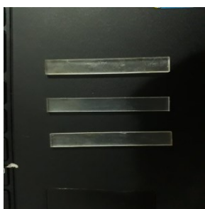
Figura 1. Matrizes acrílicas (65,00mm X 10,00 mm)
