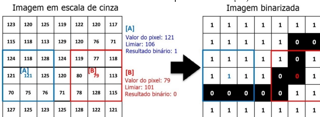
Figura 21 - Demonstração esquemática de uma binarização utilizando 3 x 3 pixels (limiar selecionado manualmente para demonstração).
