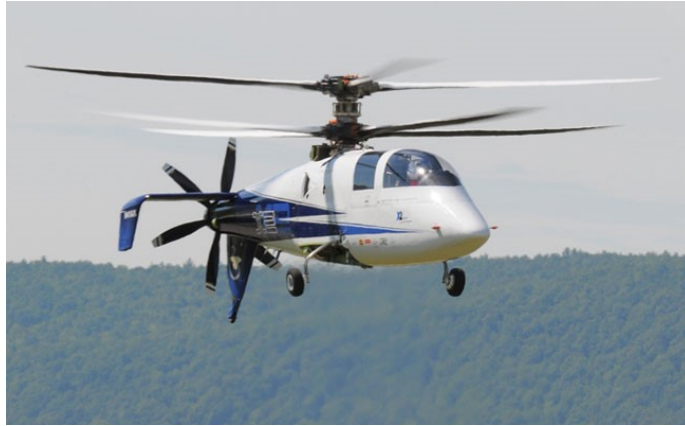
Figura 4 - Exemplo de um rotor coaxial, montado sobre o helicóptero Sikorsky X2. (www.defensereview.com. Acessado em: 20 abr. 2017).
