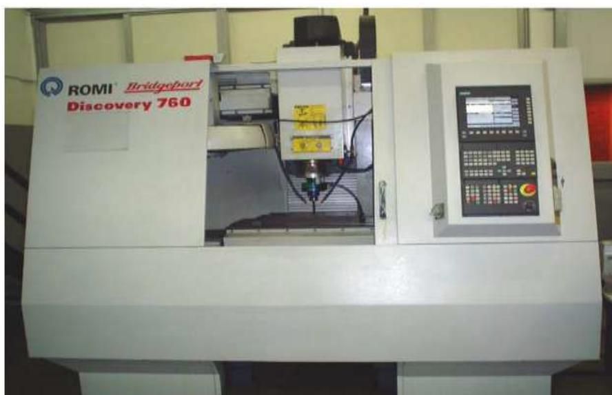
Figura 4.7: Centro de usinagem vertical CNC que foi utilizado nos testes de furação e alargamento e furação com brocas especiais (REIS A. 2014).
