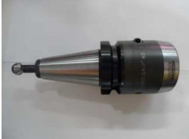
Figura 4.8: Mandril Hidromecânico Sandvik.
