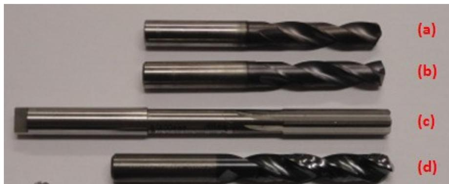
Figura 4.9: Ferramentas de metal duro utilizadas: (a) Broca de  $\varnothing$  9,5 mm; (b) Broca de  $\varnothing$  9,7 mm; (c) Alargador de  $\varnothing$  10 mm; (d) Broca especial de  $\varnothing$  10 mm (REIS A. 2014).
