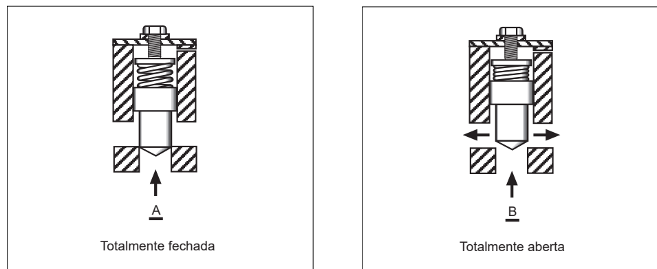
Figura 1 – Estados da válvula de pressão.
