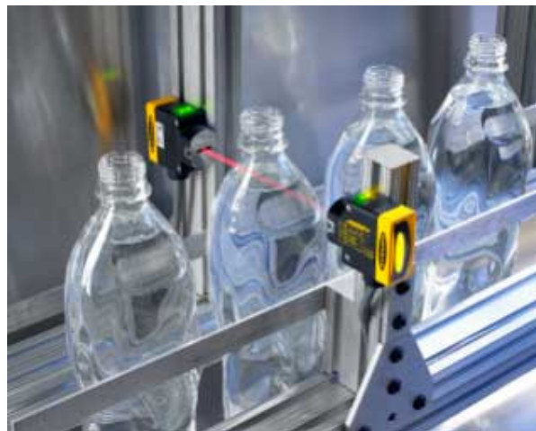
Figura 16 – Sensor fotoelétrico a laser em uma linha industrial.
